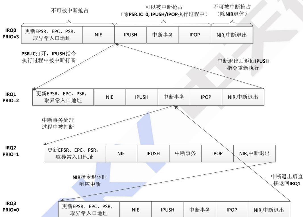
图表 3-33 中断嵌套时机条件示例
