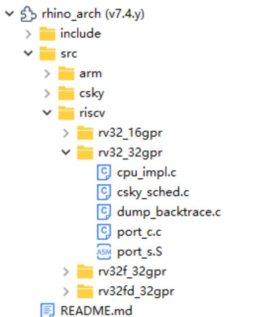
由于CH2601使用了RISC-V 32bit处理器， 我们使用rv32\_32gpr的具体实现， 根据Kernel的对接分为以下几个部分
